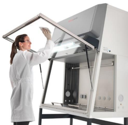
Teleskopowo unoszona szyba frontowa w komorach Herasafe
