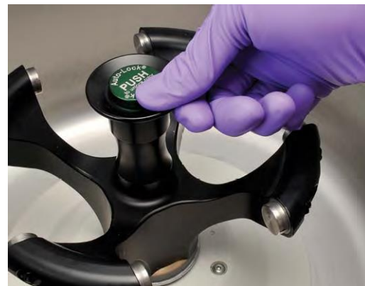
System mocowania rotorów AutoClickIII
