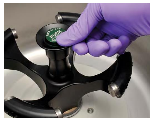
System mocowania rotorów AutoClickIII
