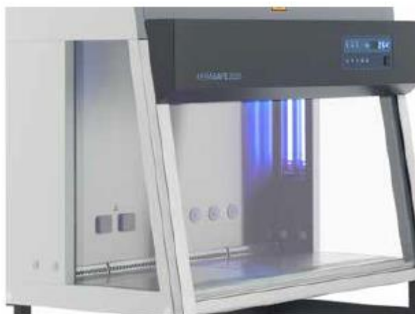
Lampy UV zapewniają sterylność wnętrza komory
