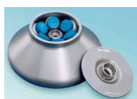
Rotor kątowy 45° Highconic
