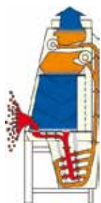
Obieg powietrza w komorze KSP
