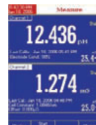
Dane kalibracji wyświetlane na dwóch kanałach
