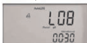
Tryb automatycznego zapamiętywania ze wskazaniem rejestrowanego
