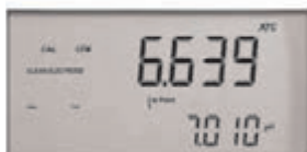
Przykład wyświetlacza wskazującego konieczność oczyszczenia elektrody
